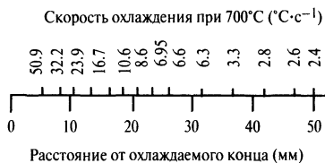
Рис. 2.4. Скорости охлаждения на различных расстояниях от закаливаемого конца образца для испытания Джоменни
